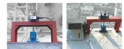
각 현장의 구조물을 설치하기 전에 매설된 찬넬을 구조계산에 의한 하중 값 이상으로 인발 테스트를 실시하여 콘크리트와 찬넬 제품에 대한 안전성을 확인할 수 있다.
